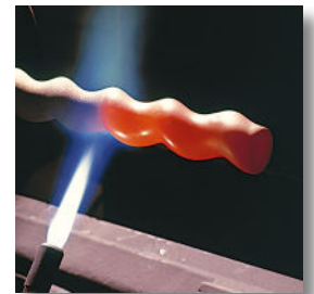
Einsintern einer Spritzschicht
